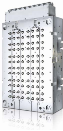
Die Abb. zeigt eines der Kernprodukte von Mold-Masters, eine sogenannte „Heiße Seite“. Es handelt sich hierbei um ein vollständiges Heißkanalsystem, eingeschlossen zwischen zwei Stahlplatten zur direkten Montage auf einer Spritzgießmaschine. Mit einem solchen System werden beispielsweise 96 Verschlusskappen für PET-Getränkeflaschen innerhalb von nur ~2,5 Sekunden hergestellt.
